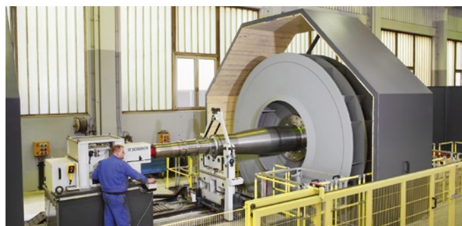
Стенд балансировочный для роторных агрегатов диаметром до 5000 мм
