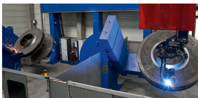
Пятиосевой роботизированный манипулятор можно эффективно использовать на нескольких сварочных станциях
