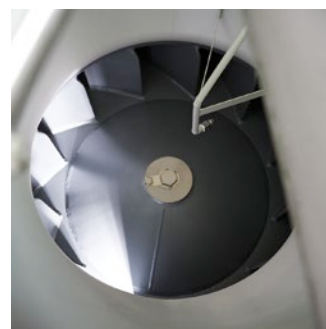
Система впрыска воды для предотвращения / уменьшения налипания
