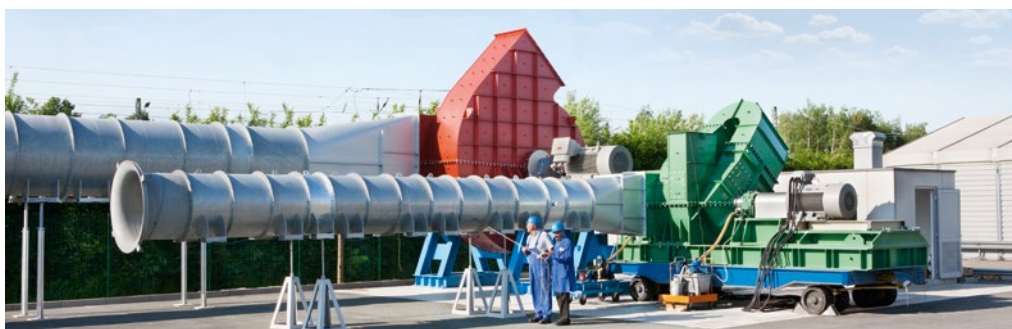
Стенд для проверки производительности центробежных вентиляторов мощностью до 1000 кВт при 400 В
